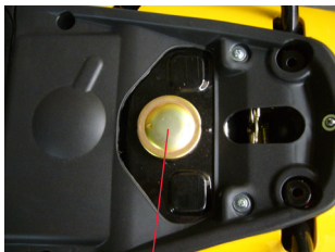
Tapa de tanque de combustible
